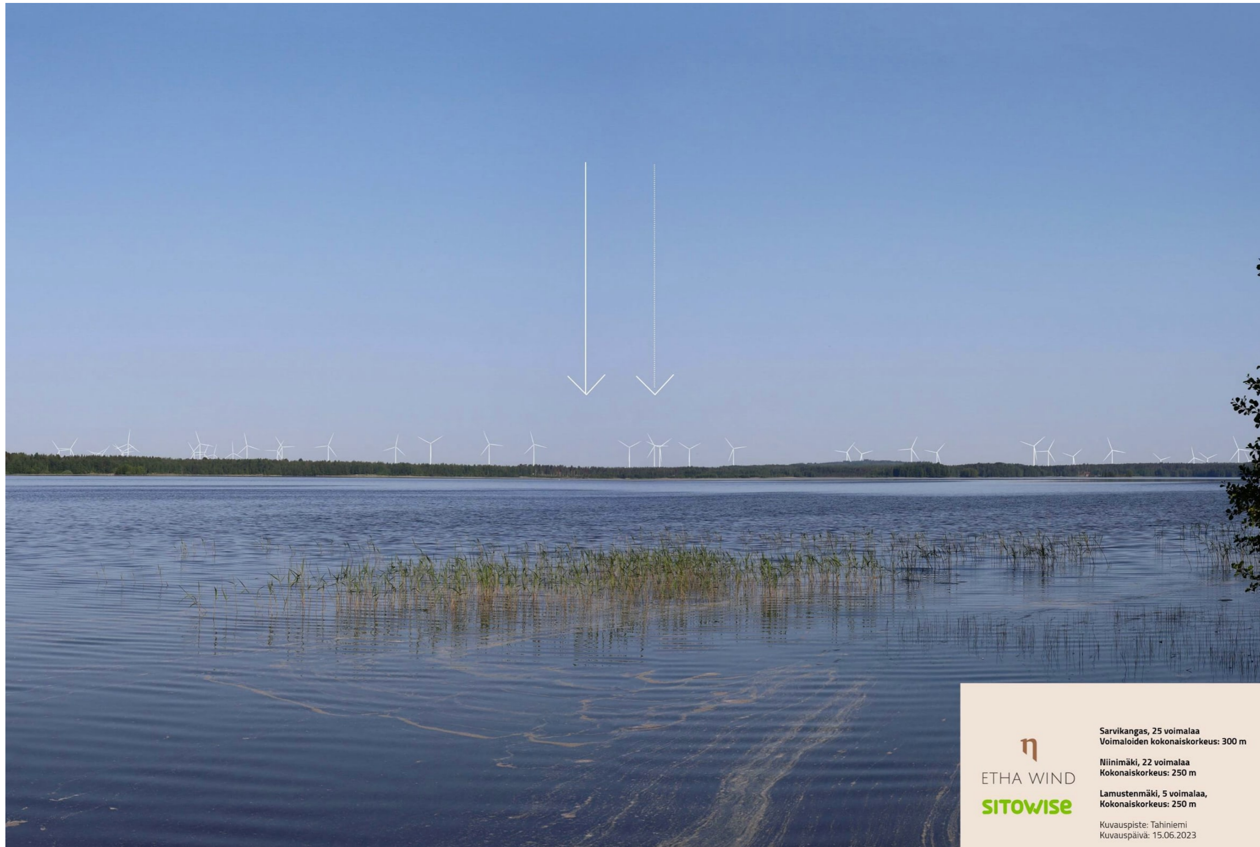
Kuva 3.4. Havainnekuva Tahiniemestä. Kuva vastaa 50 mm objektiivia. Etäisyys lähimpään voimalaan noin 12 km. Valkoiset nuolet kuvaavat Sarvikankaan voimalan 31 muuttunutta sijaintia (noin 500 m lounaaseen): katkoviiva vanha sijainti, ehyt viiva uusi sijainti.
